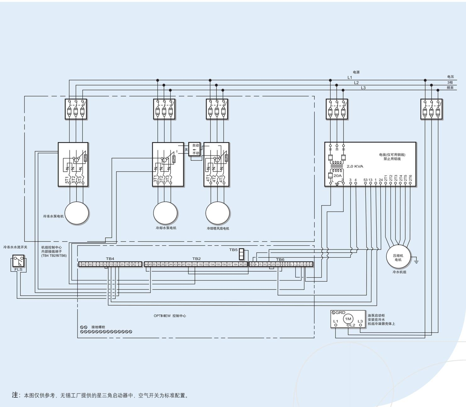
注：本图仅供参考，无锡工厂提供的星三角启动器中，空气开关为标准配置。
