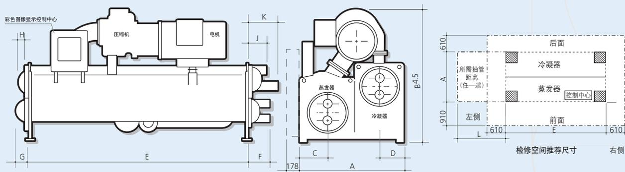
J1/J2压缩机蒸发器-冷凝器代号
