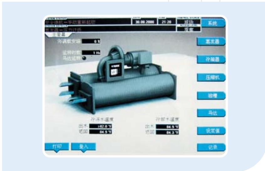
另外通过屏幕上的轻触式按键,操作员还可从8个主要界面获取冷水机组的主要信息和各部件情况。这8个界面是:系统、蒸发器、冷凝器、压缩机、油槽、电机、设定值和历史记录。而且,还可通过这些主要界面进入到其他相关界面:固态启动器界面(选项),变速驱动装置界面(选项),通信界面,销售定单界面,运行界面以及趋势图设置界面。
