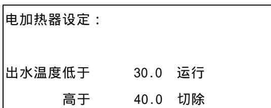
电加热器运行温度按系统出水控制,设定范围: 25.0~48.0
